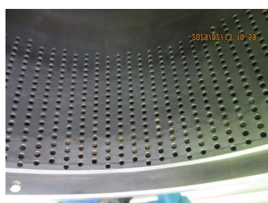
インナーケージ内側拡大（下部詰まり）
