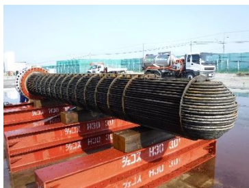
チューブバンドルジェット洗浄後
