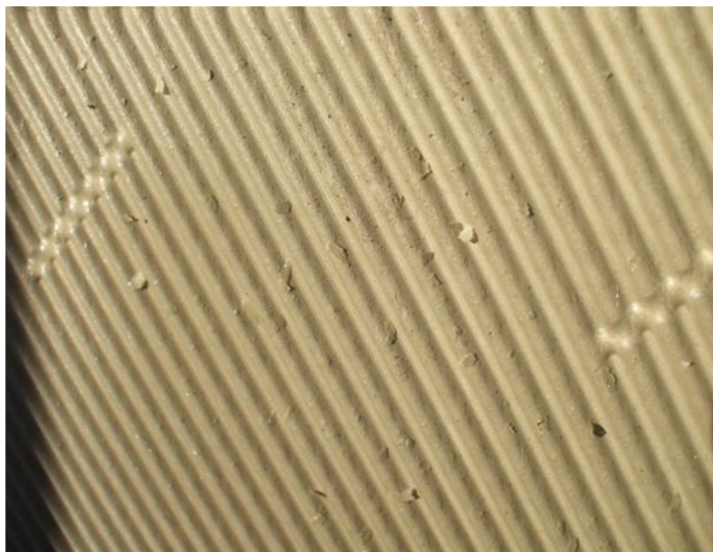
図 2.1-5 11E-001 セミリーンアミン（SLA）高温部スケール付着
