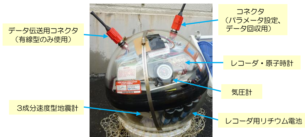
図 4.4-2 耐圧ガラス内部の様子
