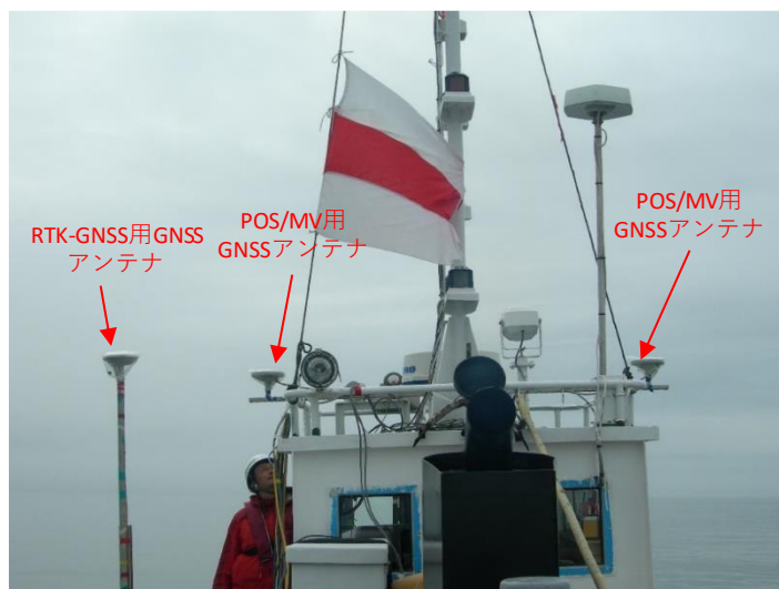
図 4.3-24 調査船に艦装した RTK-GNSS 用と POS/MV 用の GPS アンテナ
