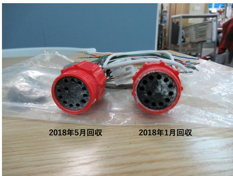
図 4.4-32 回収した OBS の 12 ピンコネクタ（一部腐食）
