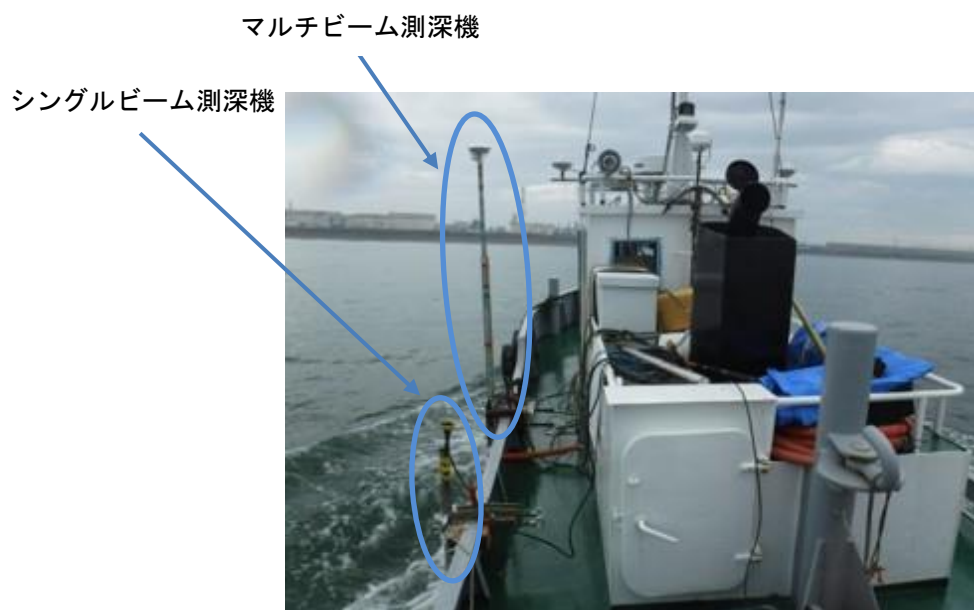
図 4.3-21 測深機（左舷手前がシングルビーム測深器、奥がマルチビーム測深機）
