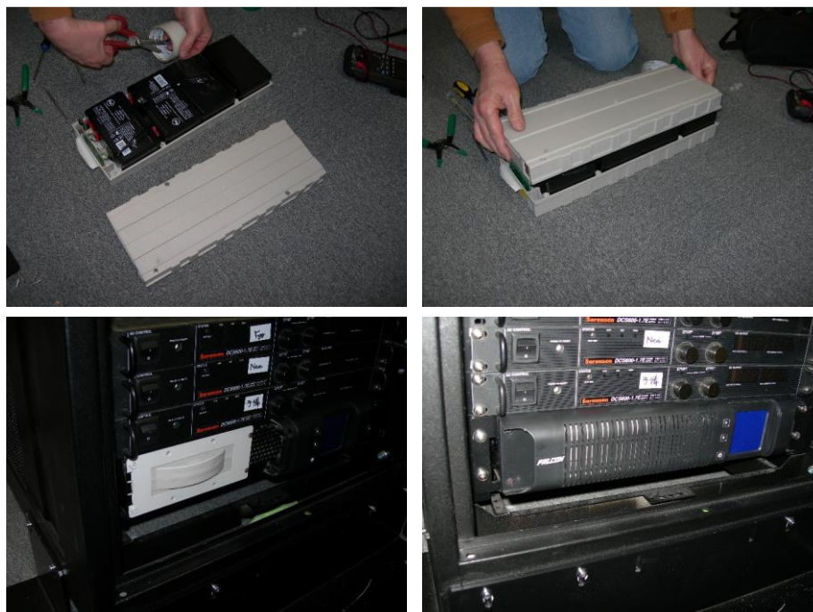
図 4.3-15 FalconUPS の内蔵バッテリー交換時の様子
