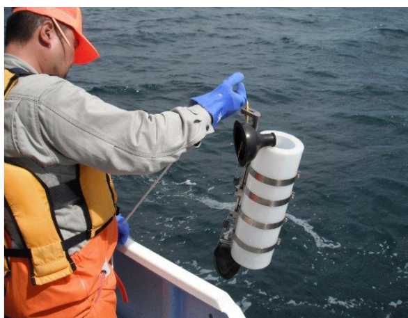
図 6.2-6 バンドーン型採水器を用いた植物プランクトン採集（イメージ）
