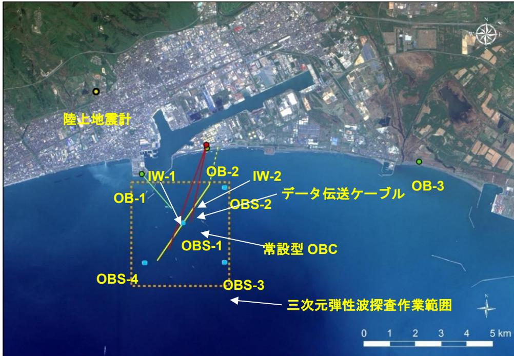
図 1.4-1 モニタリング設備の配置図
