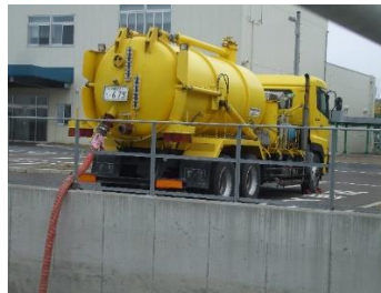
汚泥回収バキューム車
