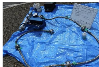
フレキシブルチューブ耐圧試験
