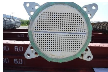
管板コーティング補修
