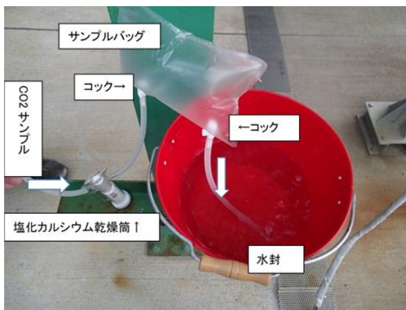
図 2.1-2(2) サンプルガス採取の様子 (2)
