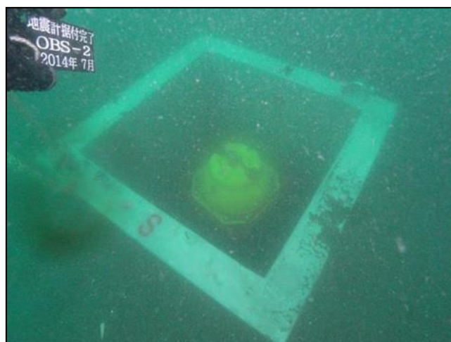
図 4.4-4 海底に設置された設置容器（蓋を取った状態）とその内部に設置された OBS
