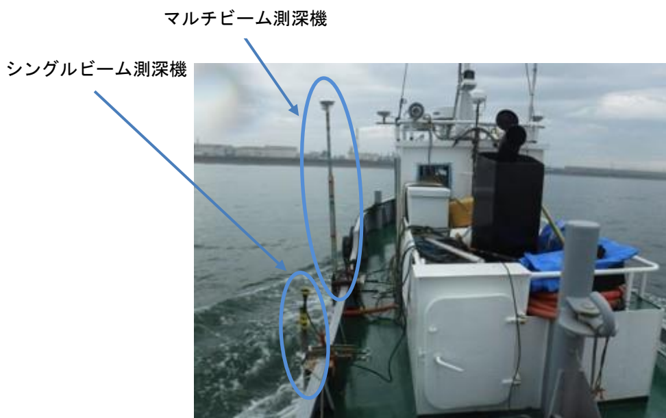
図 4.3-15 測深機（左舷手前がシングルビーム測深器、奥がマルチビーム測深機）
