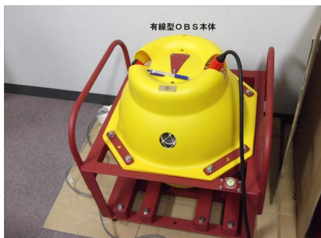
図 4.4-3 鉄製のフレームに固定した状態の OBS
