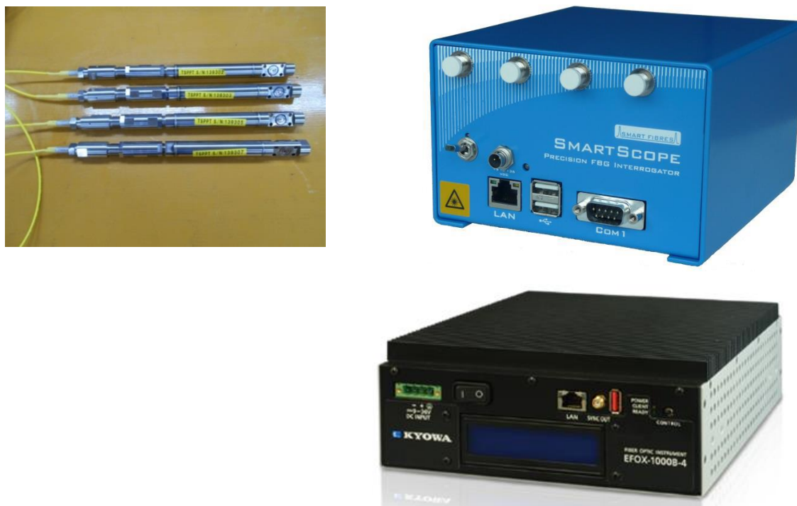
図 4.1-6 FBG センサ（左上）と FBG 地上機（右上：従来機、右下：新機種）
