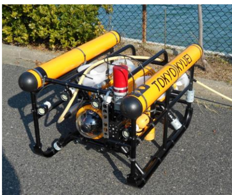
図 6.2-8 メガロベントス調査に用いた遠隔操作無人探査機
