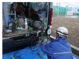
圧力計精度検査
