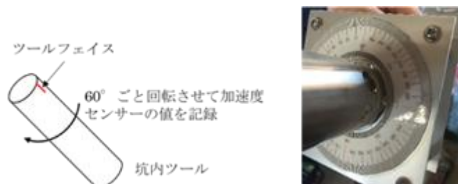
図 4.1-34 ツール回転角確認作業模式図と回転角チェック機材
