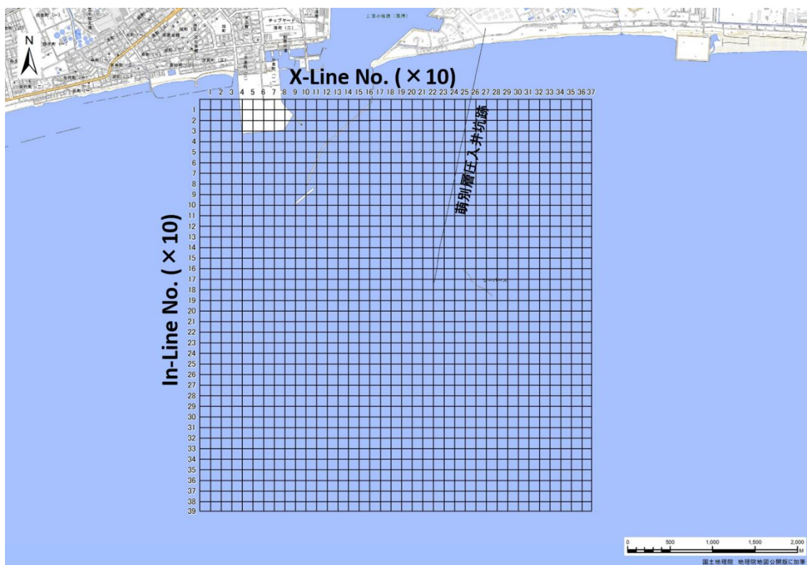
図 4.7-13 重合測線図（三次元調査）
