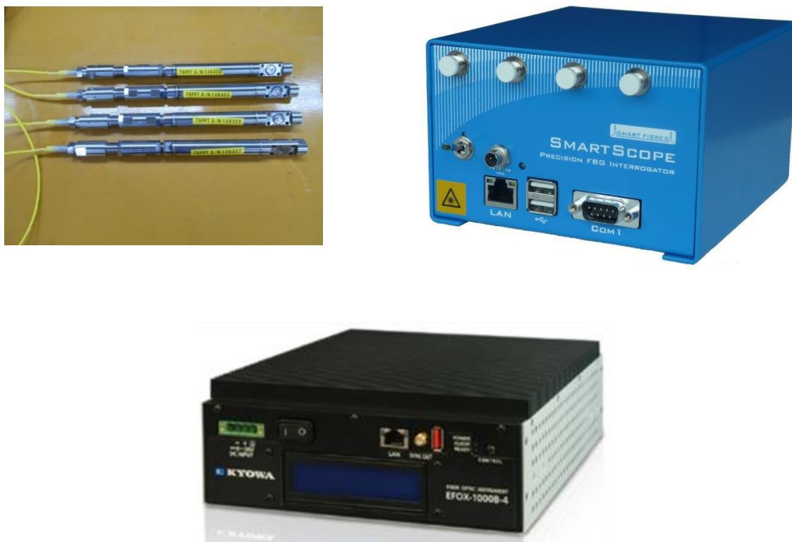
図 4.1-6 FBG センサ（左上）と FBG 地上機（左上：従来機、下：新機種）
