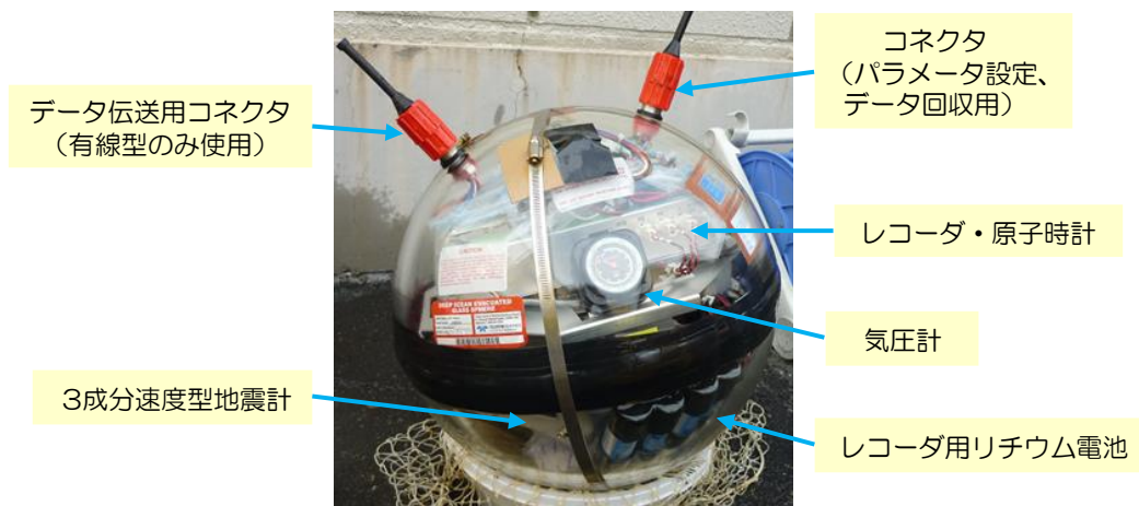
図 4.4-2 耐圧ガラス内部の様子
