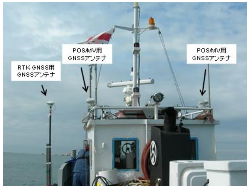
図 4.3-18 調査船に艦装した RTK-GNSS 用と POS/MV 用の GNSS アンテナ
