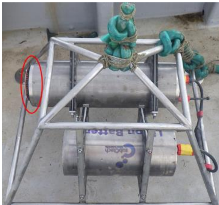
図 6.10-3 係留系に付帯した MK2（写真上側、メンブレンは赤丸側に位置）、および水中 Li-ion 充電電池パック（写真下側）の外観
