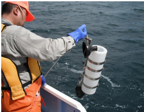
図 6.2-5 バンドーン型採水器を用いた植物プランクトン採集（イメージ）
